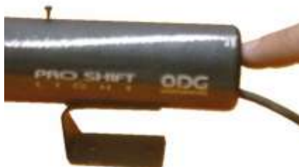
2- Empurre o núcleo com suavidade até sair somente a lâmpada
